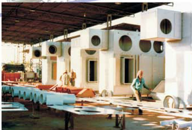
Caixas de tomada de ar acusticamente isoladas
