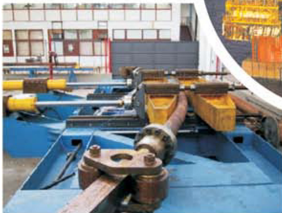
Equipamentos para teste em juntas soldadas de Dutos rígidos/flexíveis Coppe - UFRJ
