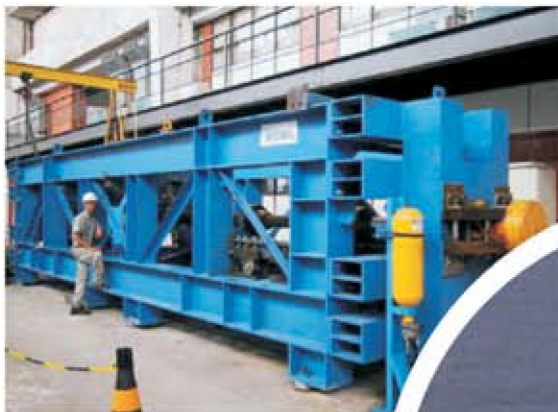
Equipamentos para teste em juntas soldadas de Dutos rígidos/flexíveis Coppe - UFRJ
