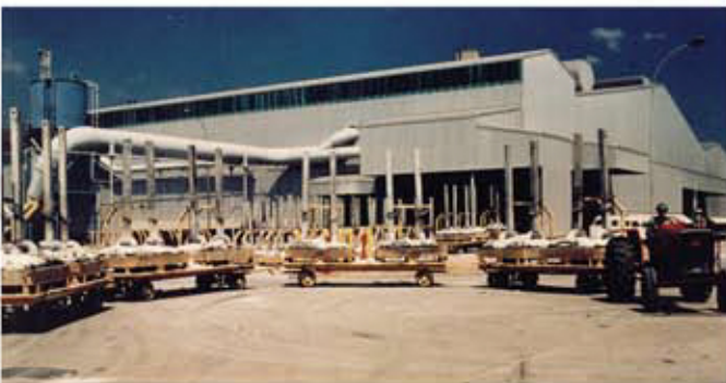
Comboio de carretas bidirecionais para transporte de anodos, suspensão rígida capacidade de 4 toneladas Cliente: VALESUL ALUMÍNIO
